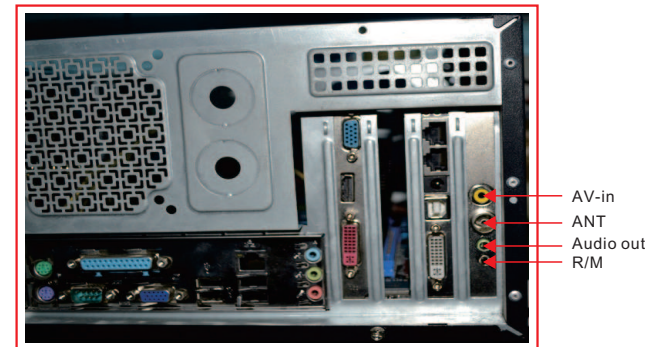
将电视卡插入PCI插槽内
