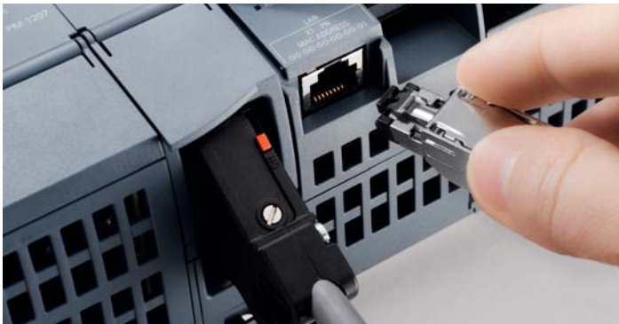
精简系列面板与 SIMATIC S7-1200 CPU 的连接
