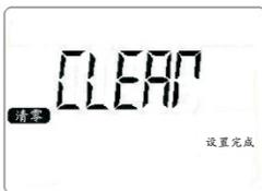
清零，即将总量强制置零。选择此项后，系统会自动开始设置，此时请不要按任何按键，约3秒后屏幕显示“设置完成”。随后，仪表会自动返回菜单选择。界面如左图。
