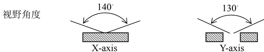
图 4 探测器视野角度示意图
