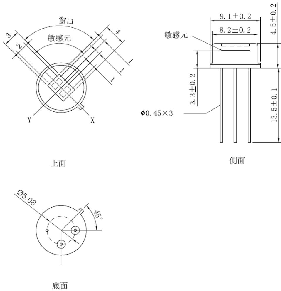
图 1 探测器外形尺寸示意图
