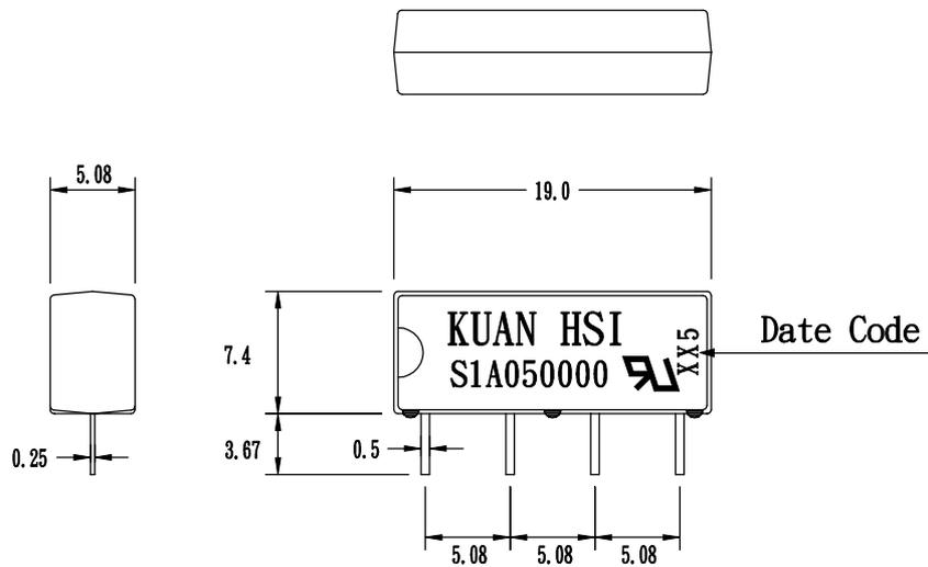
TOLERANCE :  $\pm 0.1\text{mm}$
