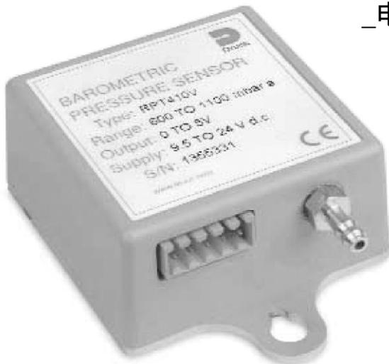
RPT 410系列硅压阻压力变送器(RPT)采用先进的压力传感技术，为大气压的测量提供了高精度以及优良的长期稳定性。例如：Druck RPT 技术应用于航天器中大气数据处理系统，在此，可靠的绝对压力的测量是至关重要的。多层的压力芯子，在Druck先进的100级洁净间中制造出来，它包含了谐振器和压力传感器膜片。压力传感器的膜片是一小片单晶硅片经过微加工而得。这些可以使RPT 410系列的性能得到大大地提高。RPT410系列可以提供与大气压线性对应的频率输出和电压输出两种形式。在很宽的工作范围内，精度保持不变。内置触发器NO/NC可以补偿电流的损耗。RPT 410 是气象监测站和发动机气压测量最理想的选择，以及高稳定性的压力传递基准。
