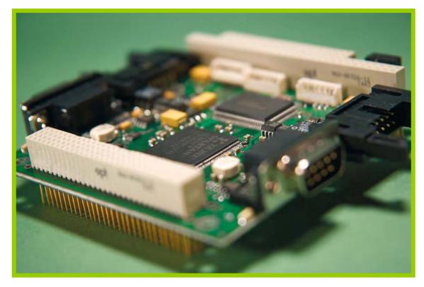
Kvaser PC104+板具有紧凑、自堆栈的特性,其灵活的 PC104+的参数,大量减少了嵌入系统开发的时间和成本。Kvaser PC104+板是一个双通道的 CAN 总线分析仪,板上带有高性能的微控制器。
