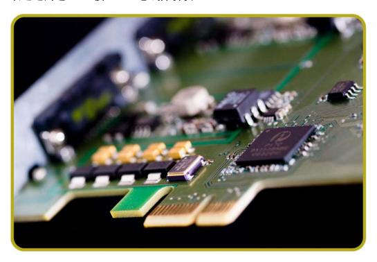
Kvaser PCIEcan 产品是高速 PCIX 接口 CAN 总线分析仪,该产品可无损耗的发送、接收 CAN 总线标准帧和扩展帧。
