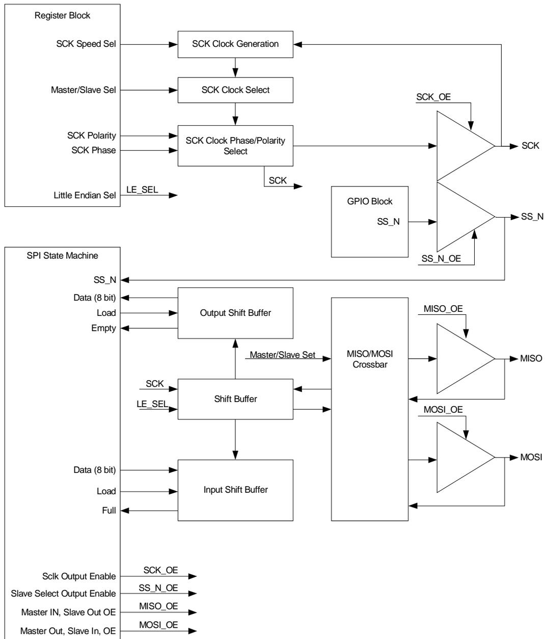
**Figure 16-1. SPI Block Diagram**
