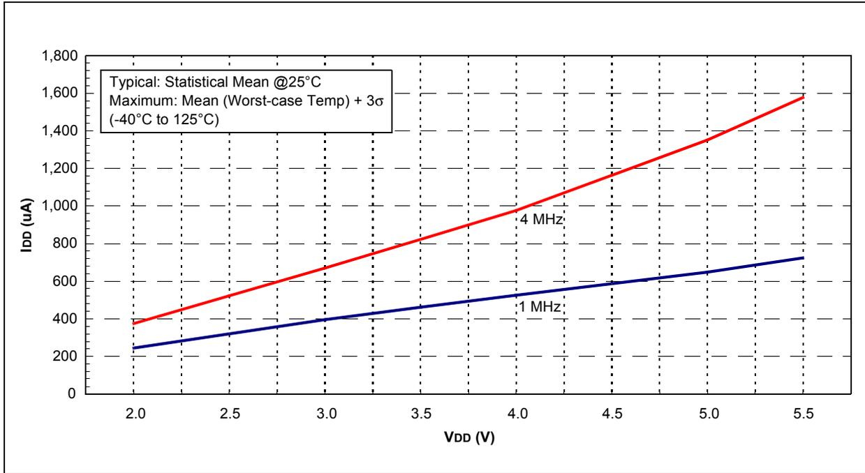
FIGURE 20-7: TYPICAL I<sub>DD</sub> vs. V<sub>DD</sub> OVER F<sub>osc</sub> (EXTRC MODE)
