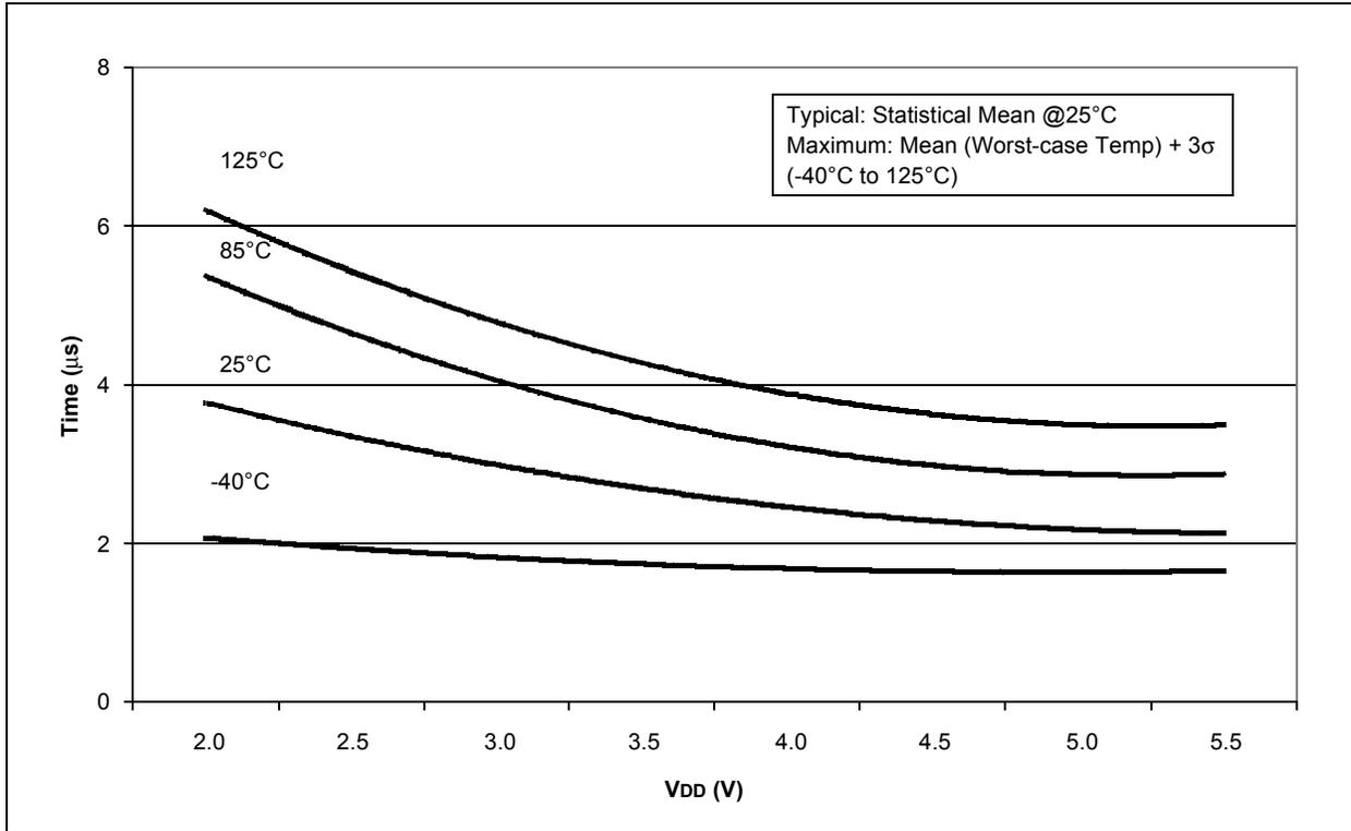
FIGURE 20-35: TYPICAL HFINTOSC START-UP TIMES vs. V<sub>DD</sub> OVER TEMPERATURE
