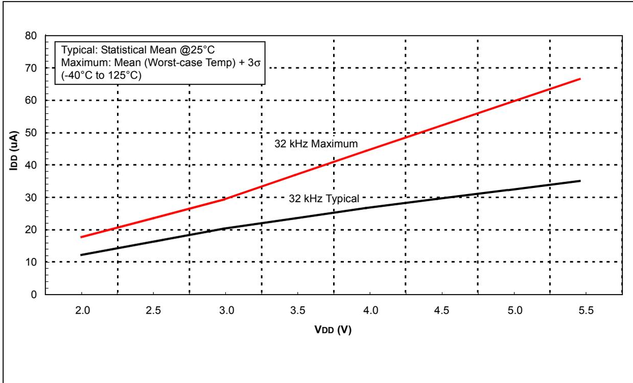
FIGURE 20-11: TYPICAL I<sub>DD</sub> vs. F<sub>osc</sub> OVER V<sub>DD</sub> (HFINTOSC MODE)
