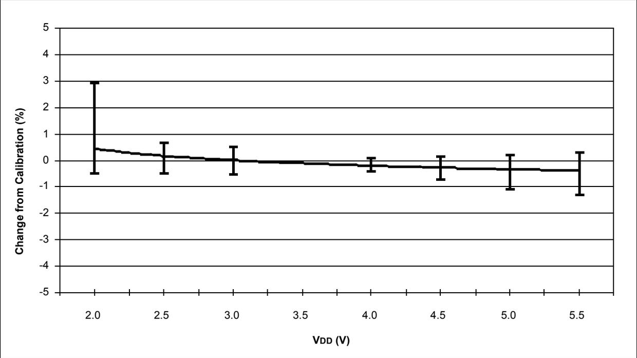
FIGURE 20-39: TYPICAL HFINTOSC FREQUENCY CHANGE OVER DEVICE V<sub>DD</sub> (85°C)
