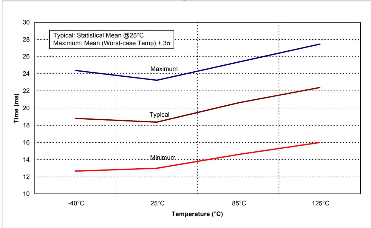
FIGURE 20-21: CV<sub>REF</sub> IPD vs. V<sub>DD</sub> OVER TEMPERATURE (HIGH RANGE)
