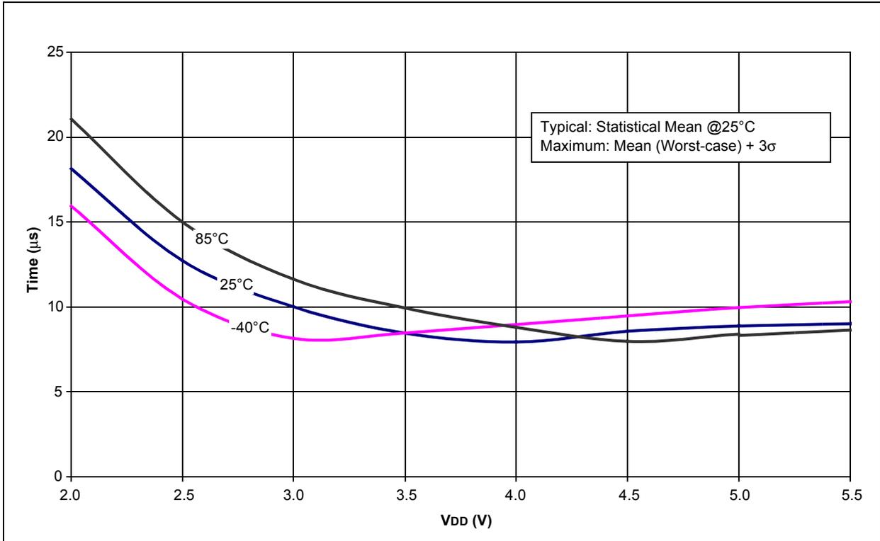
FIGURE 20-37: MINIMUM HFINTOSC START-UP TIMES vs. V<sub>DD</sub> OVER TEMPERATURE
