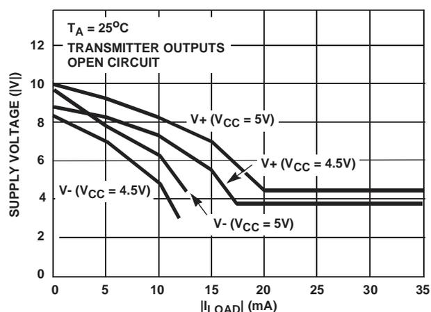
FIGURE 6. V<sub>+</sub>, V<sub>-</sub> OUTPUT VOLTAGE vs LOAD (HIN232)
