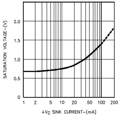
FIGURE 15. OUTPUT SUPPLY SATURATION VOLTAGE VS.  $I_{SINK}$
