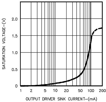
FIGURE 14. OUTPUT DRIVER SATURATION VOLTAGE VS.  $I_{SINK}$
