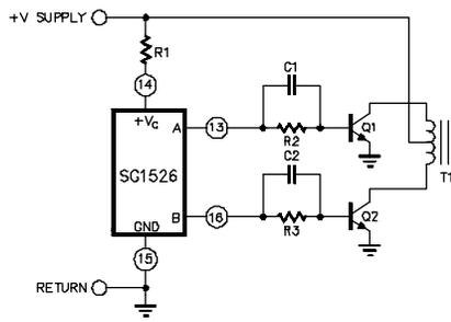
FIGURE 23. PUSH-PULL CONFIGURATION
