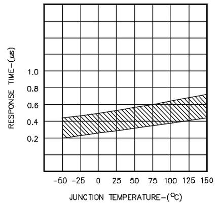
FIGURE 13. SHUTDOWN INPUT TO DRIVER OUTPUT DELAY
